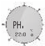
Рисунок 8. Индикация настройки комфортной температуры
